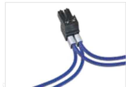
Abb.: 2-poliger Steckkontakt mit Kabelanschluss (Kabeltyp: 2 x 0,75 mm<sup>2</sup>) über Twin-Aderendhülsen
